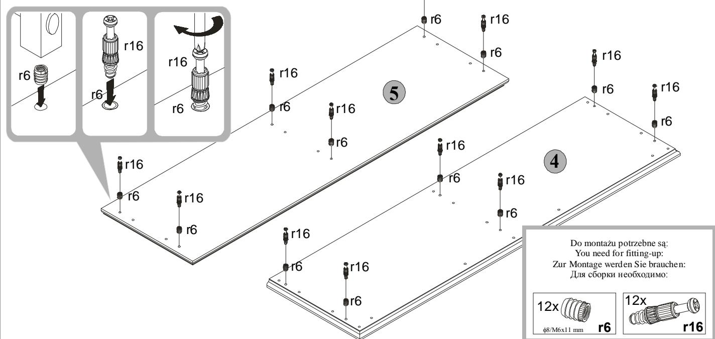
**PL** Do wieńca dolnego 4 przykręcić nóżki wraz z listwami cokołowymi wkrętami typu konfirmat e8 (konfirmaty e8 dokręcić tak, żeby nie wystawały ponad wieniec).
