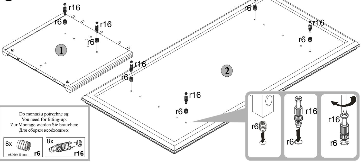
**PL** Złożyć segment zgodnie z rysunkiem i połączyc złączem mimośrodowym **r1**, używając do tego celu kluczyka **z1**.
